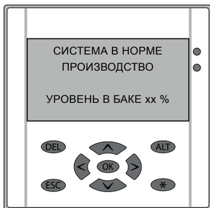
Рис. 9 Управление и отображение посредством главного экрана дисплея
